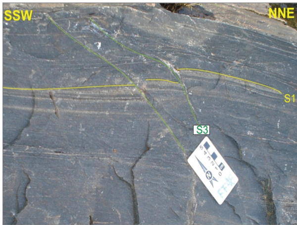
Figura 10. Afloramento do Gnaiss Taquarussu no qual o bandamento gnáissico ( S_1 ) está afetado por falhas relacionadas à fase D_3 .
